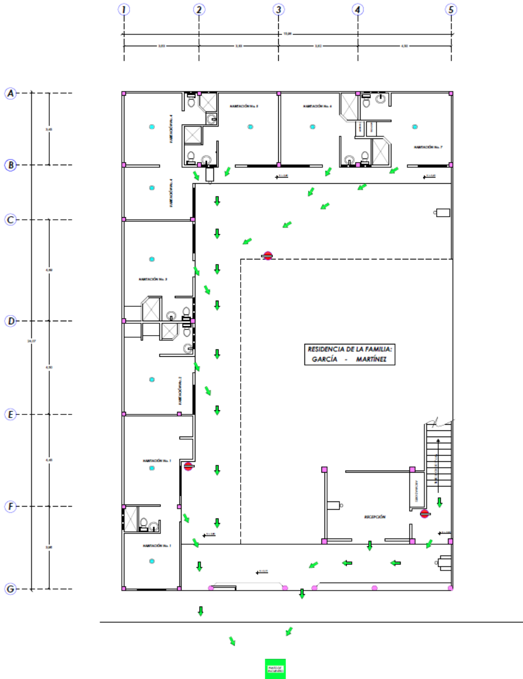
Vista de rutas de evacuación de la planta baja
